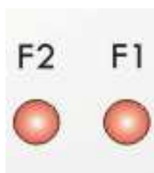
Fig. 5 – Detalhe dos LEDs indicadores de fusível queimado
